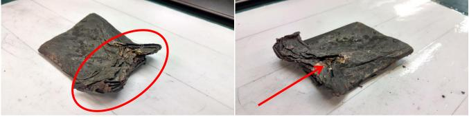
Fizemos uma análise detalha da bateria através de imagens de Raio-X provando que a mesma sofreu uma intrusão por alguma ferramenta pontiaguda. As duas imagens superiores mostram a célula da bateria danificada pela carbonização, mas com as camadas internas íntegras em boa parte da bateria, sendo que as duas imagens inferiores mostram como ficaram as camadas da bateria na região de intrusão (todas danificadas devido ao dano físico causado pelo uso de ferramenta pontiaguda).
