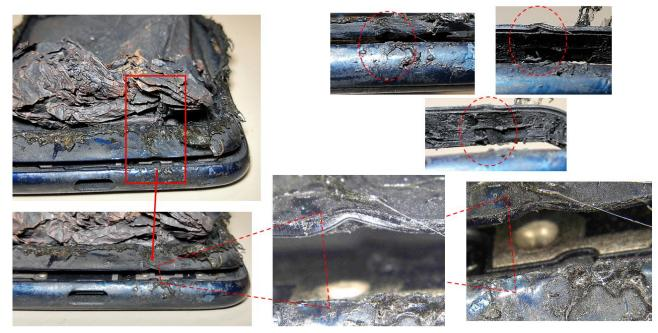
A célula da bateria foi analisada e apresenta uma abertura causada por tentativa de remoção de forma indevida, não apresentando qualquer sinal de derretimento na placa principal e/ou de qualquer evento interno na placa principal que possa ter gerado calor e causado sua abertura.
