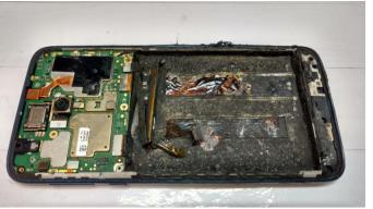
Na terceira foto observamos a bateria posta junto ao chassi de onde os danos no produto foram iniciados. Os danos apresentados pela bateria na região demarcada condizem com a tentativa de remoção da bateria que se deu na parte inferior do aparelho.
